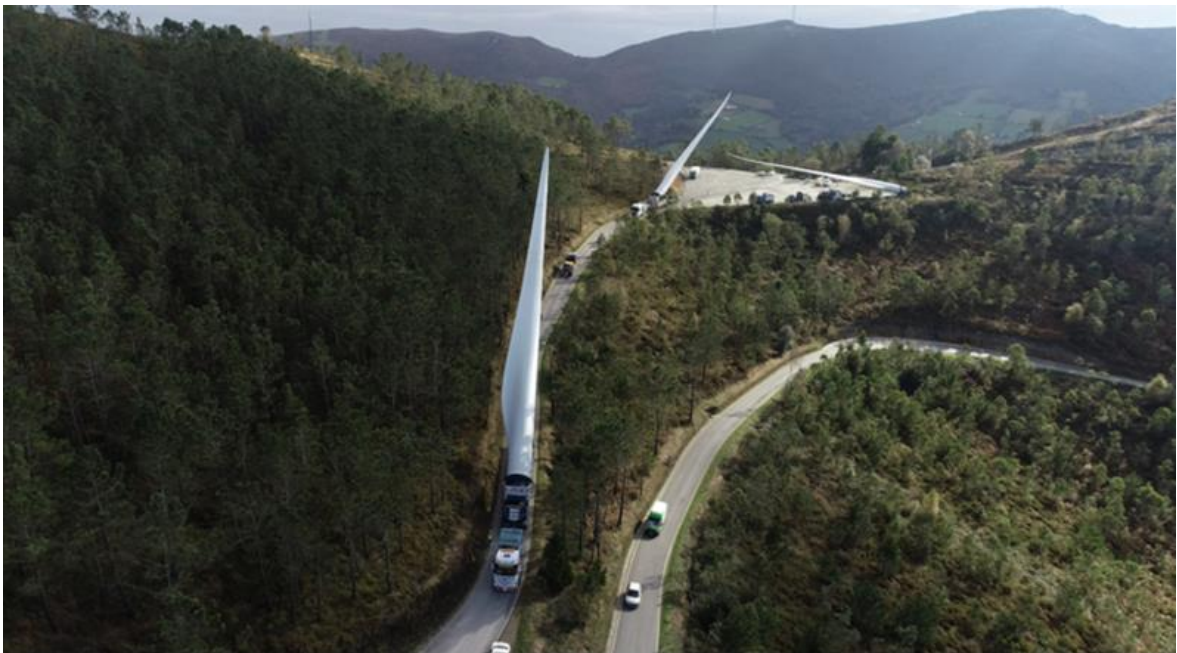
Figura 4 – Transportes de palas mediante blade lifter. Fuente: www.capitalenergy.com
